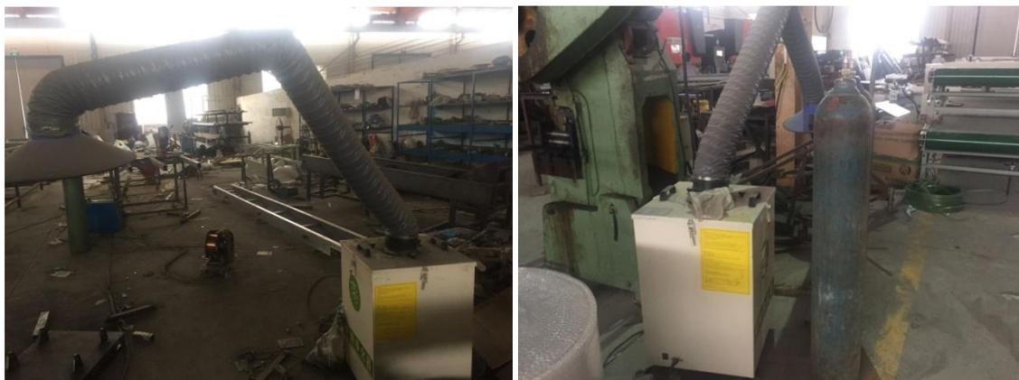
图 4-1 移动式焊烟净化器照片
